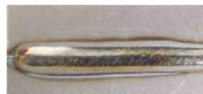
«Нержавейка», толщина 6мм, шов полученный в режиме «замочная скважина»
