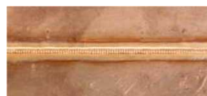
Медь, толщина 0.6мм, шов полученный в режиме Plasma-плавка
