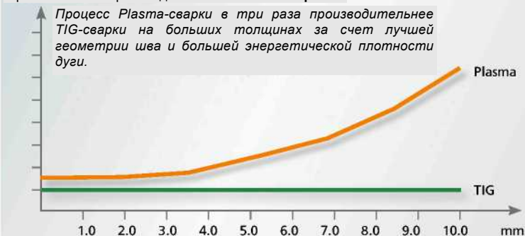
Плазма-сварка предпочтительней TIG-сварки на всех толщинах материалов
